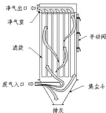
图 8.1-4 脉冲布袋除尘器结构图
