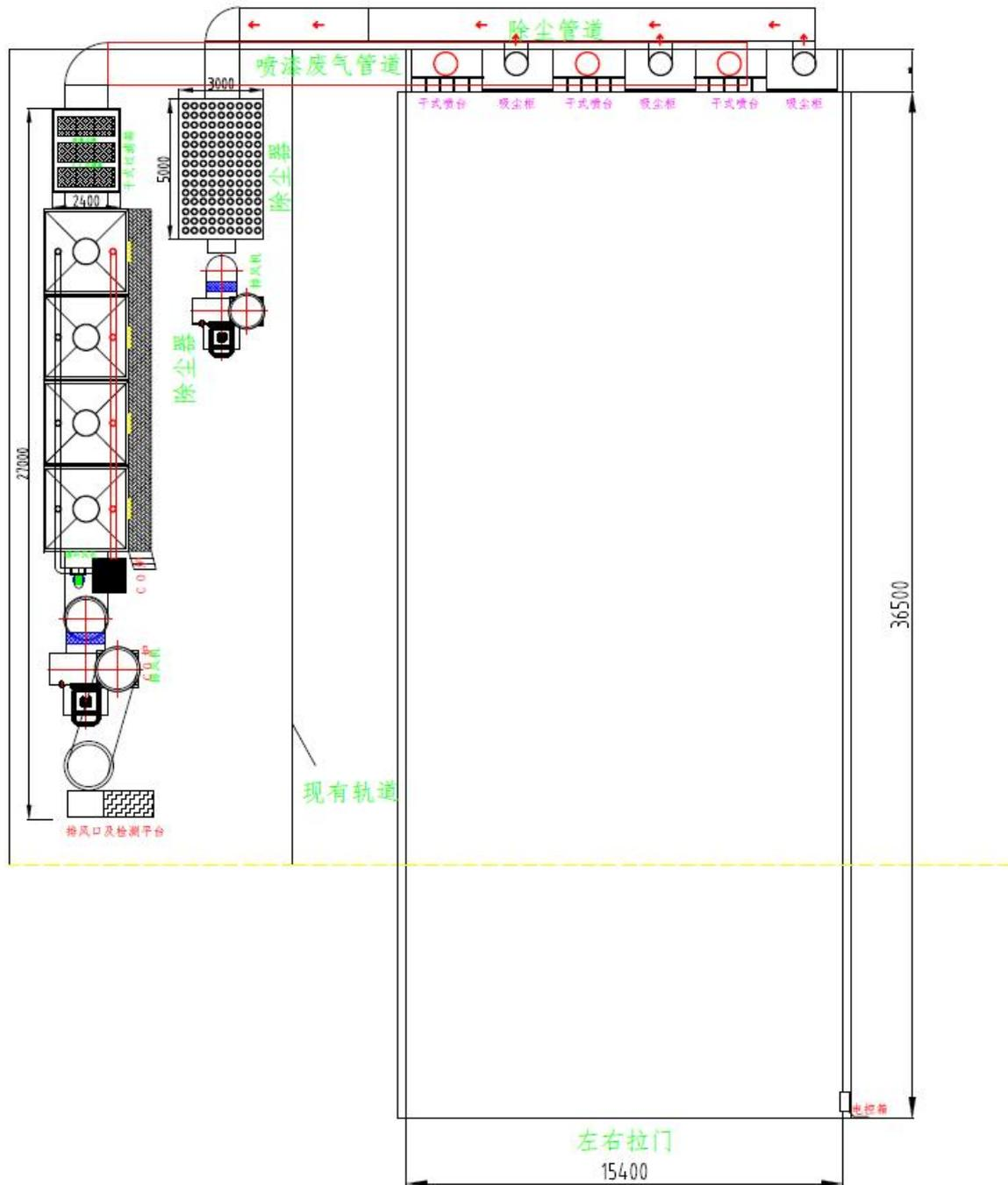
图 8.1-1 喷漆房整体布局图
