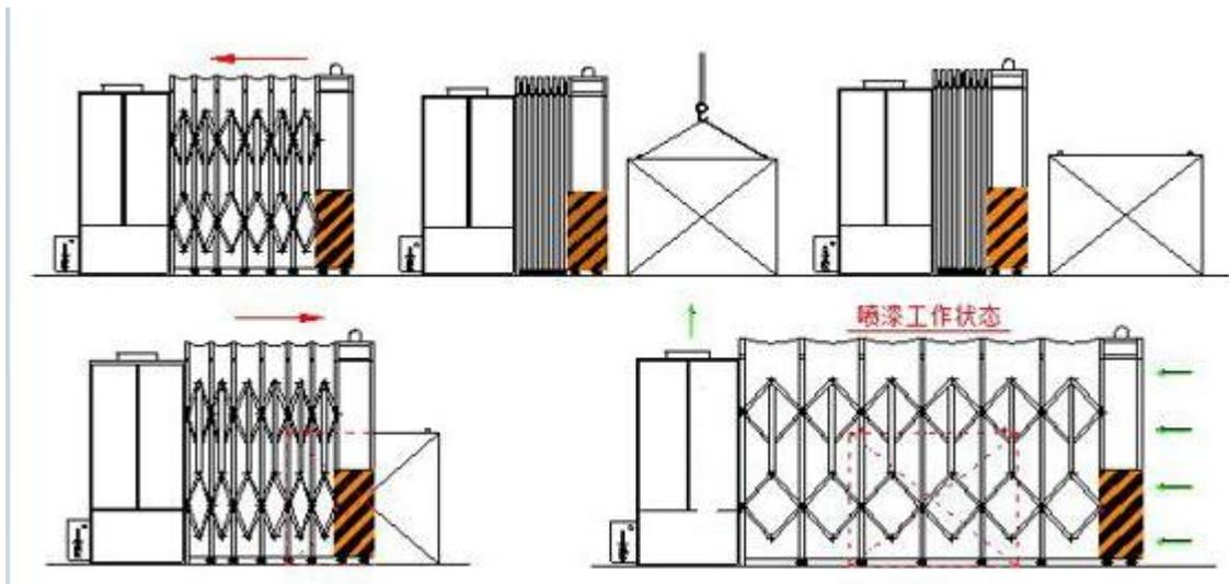
图 8.1-3 伸缩式喷漆房工作原理图
