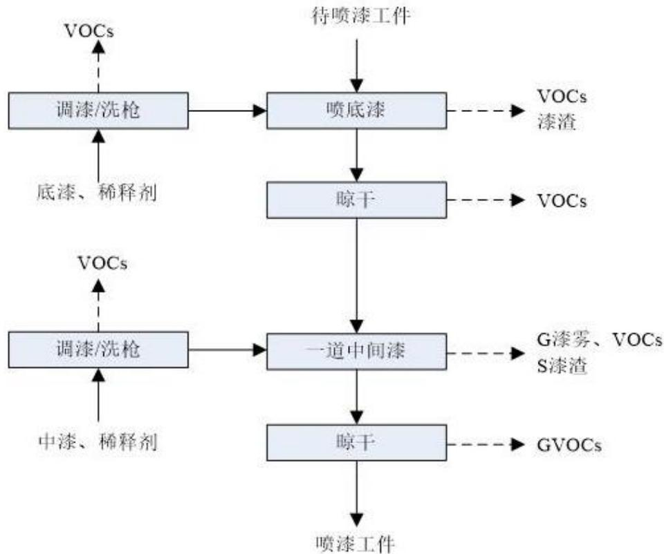
图4.3-2 喷漆工序生产工艺及产污流程图
