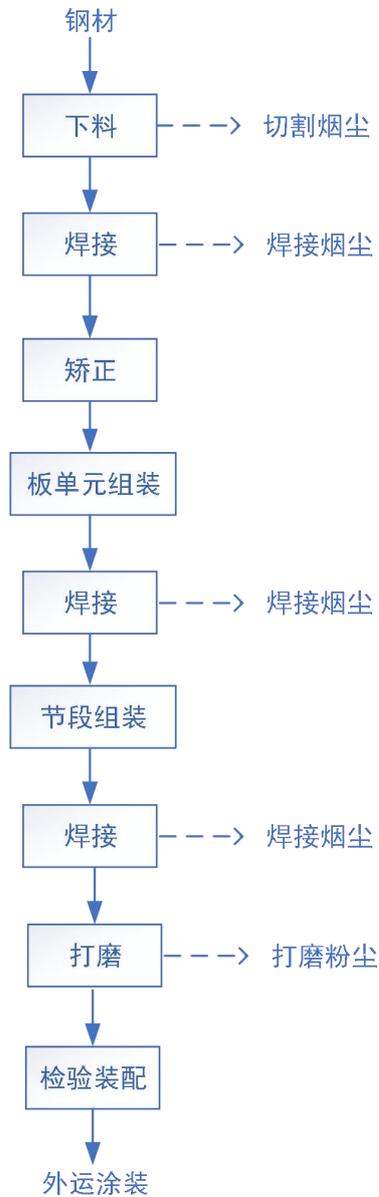
图3.3-2 项目验收及实际生产工艺及产污流程图
