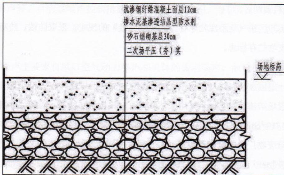
图 6.4-4 一般污染区防渗结构示意图
