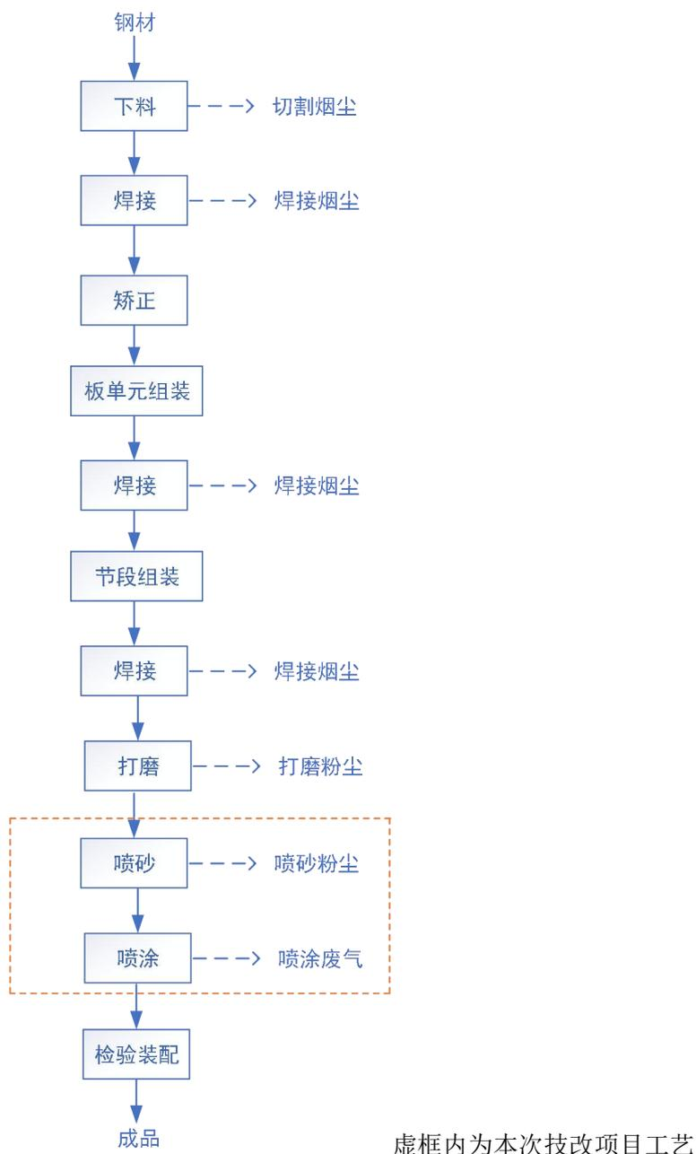
图4.3-1 桥梁钢结构生产工艺及产污流程图
