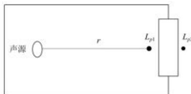
图 6.5-1 室内声源等效为室外声源图例
